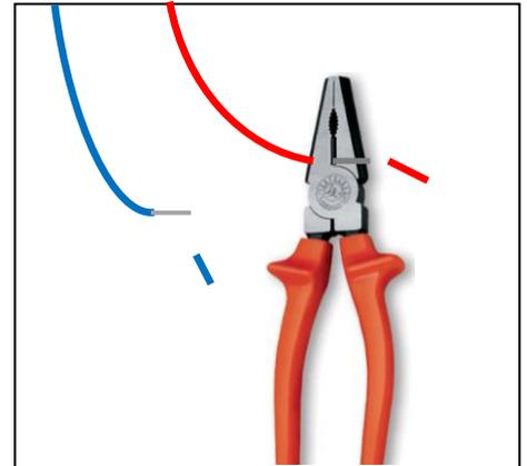
3° Pegue seu filtro MB-400 e com alicate, remova cerca de 1 cm da extremidade dos cabos que forem ser usados na instalação.
