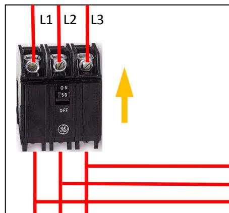
8° Ligue o disjuntor geral os três leds do **Magbras** devem acender indicando que esta instalado corretamente.
