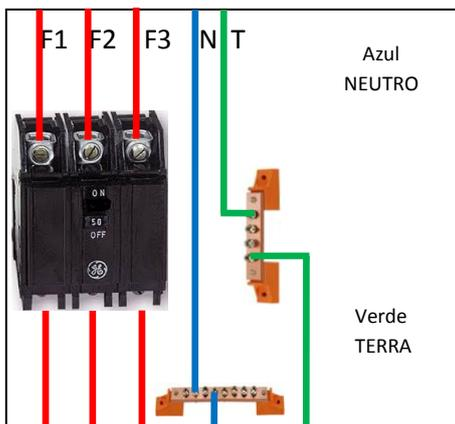
4° Retire a tampa do quadro de disjuntores e localize as fases, neutro e aterramento (se houver).
