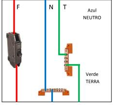
4° Retire a tampa do quadro de disjuntores e localize fase, neutro e aterramento (se houver).
