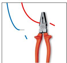
3º Pegue seu filtro MB-200 e com alicate, remova cerca de 1 cm da extremidade dos cabos que forem ser usados na instalação.
